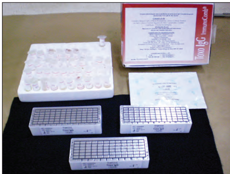
Figura 1 – kit comercial ImmunoComb ® II Toxo IgG , da Orgenics ®. Usado para a detecção de anticorpos IgG específicos anti- Toxoplasma gondii , pelo ensaio imunoenzimático indireto em fase sólida ( indirect solid-phase enzyme immunoassay – EIA).
